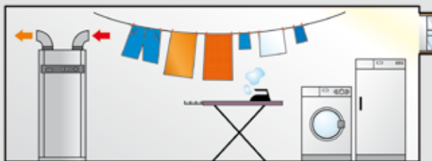
Aufstellung einer Warmwasser-Wärmepumpe im Keller/Hausarbeitsraum
